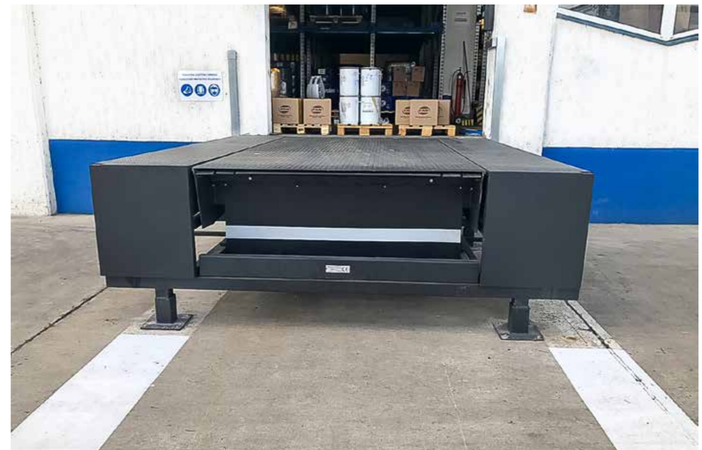
slika 47. Elektrohidraulična teleskopska rampa sa čeličnom samonosivom platformom, ispred objekta
