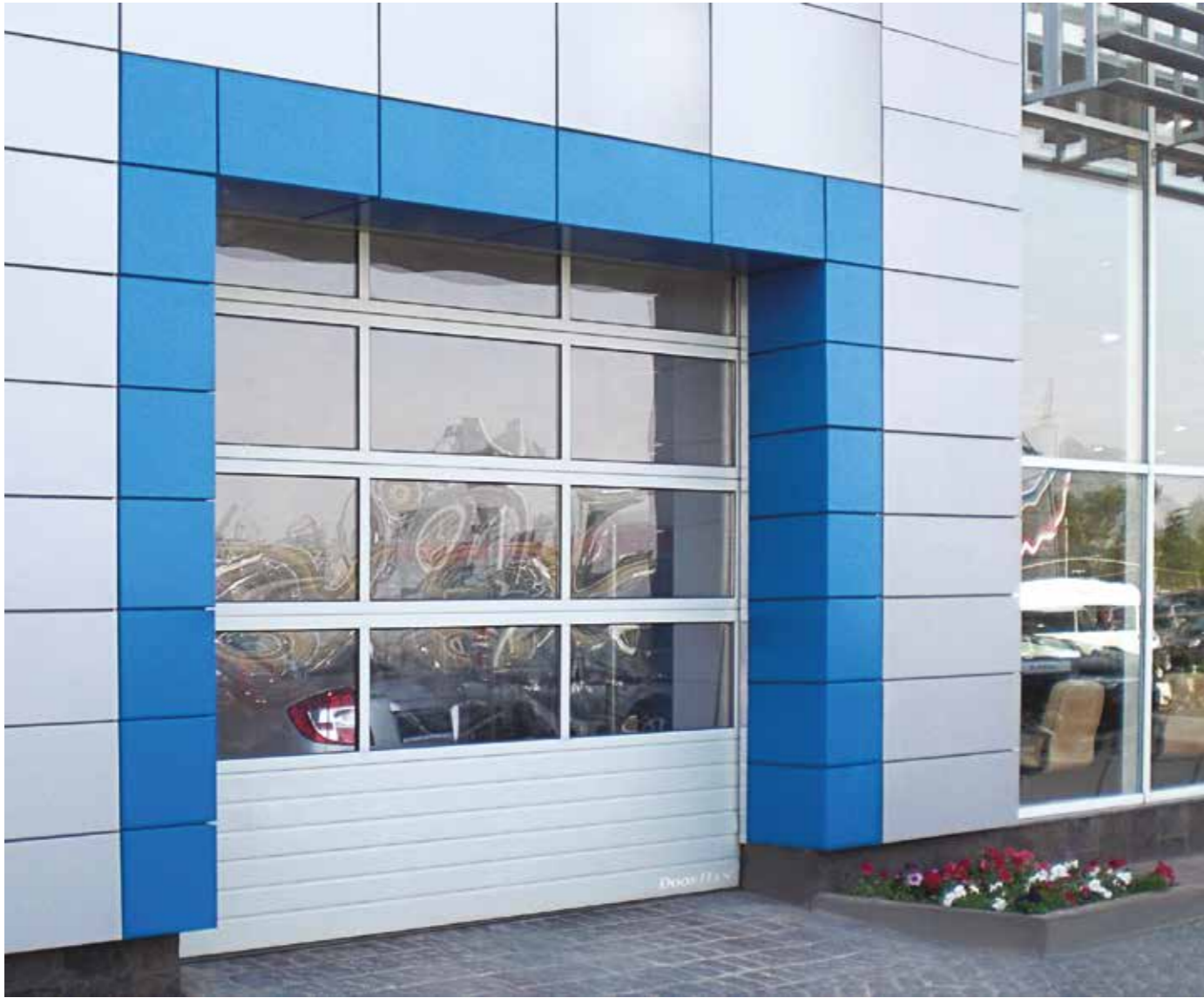
slika 23. Segmentna panorama full vision vrata sa aluminijumskim panelima i transparentnim dvostrukim pleksiglasom
