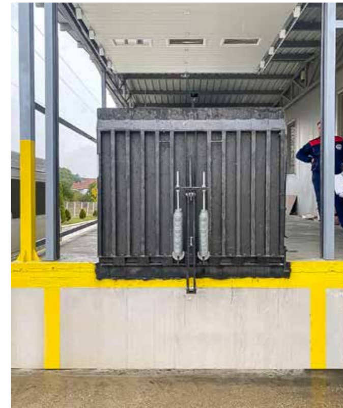
slika 45. Ručna pretovarna rampa za brzu i laku manipulaciju, potpomognuta oprugama
